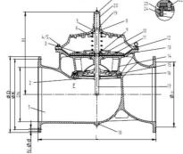
Unit: mm Dimension: ØK N-Ød DN Model Code L H PN10 PN16 PN25 PN10 PN16 PN25 PN16 PN10 PN16 PN25 PN10 PN25 \*450 A900-0450 1200 720 640 640 670 565 585 600 20-Ø28 20-Ø31 20-Ø37 530 600 A900-0600 1450 770 20-Ø31 20-Ø37 20-Ø40 885 840 840 845 725 770 682 720 800 A900-0800 1850 1260 1025 1025 1085 950 990 24-Ø34 24-Ø40 24-Ø49
